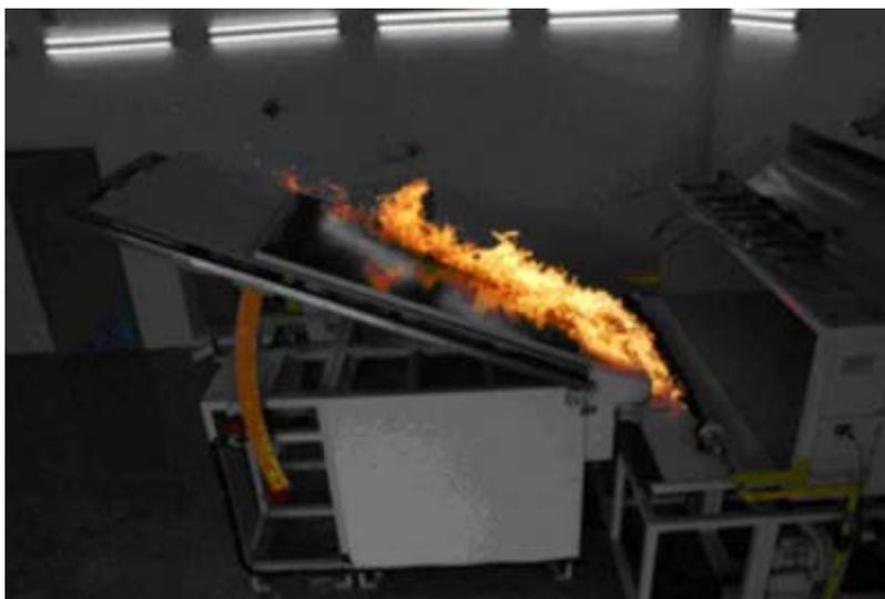
太陽光電模組耐火試驗，包括木堆燃燒和火焰蔓延兩項主要測試方法。木堆燃燒測試的目的是為了模擬鄰近建築物或生物遭遇火災以及未預期的外來火源時，掉落或揚起的燃燒物體落在太陽光電模組上的影響(例如台灣常見的炮竹煙火餘燼掉落在建築物屋頂上的太陽光電模組上)。防火等級由高而低可分為A、B、C三個等級，防火等級愈高使用的木塊體積愈大、熱能大而集中、持續燃燒時間也更久，試驗條件相對愈嚴苛。
