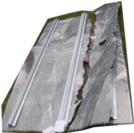
若模組符合下述任何一個標準，則模組可被視為是合格通過模組破裂測試：
